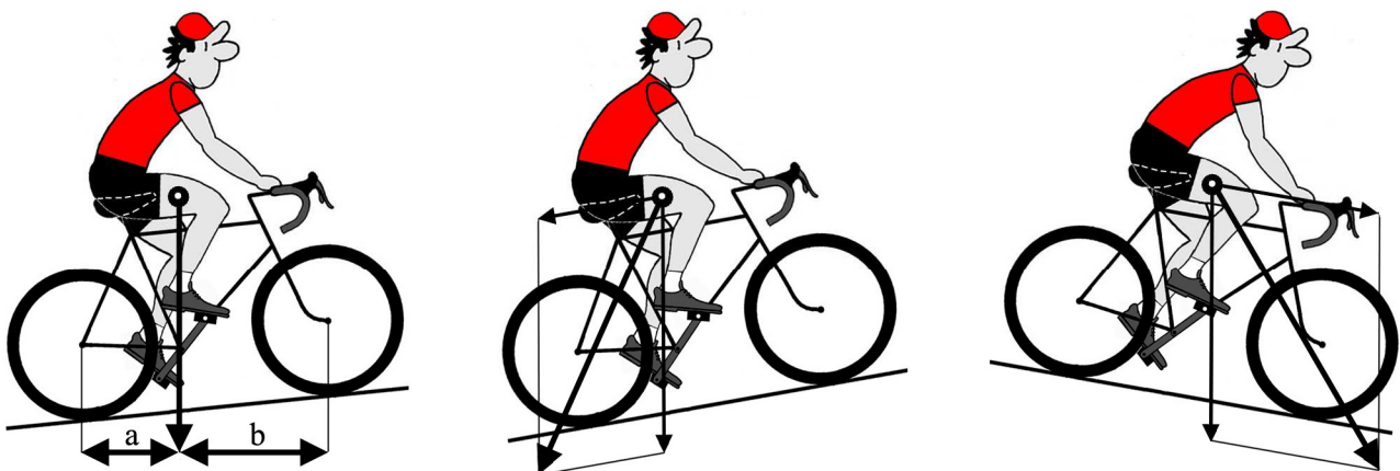
Figure 10.15. Répartition du poids sur les deux roues en fonction de la pente (ici 10 %). Figures 10.16 et 10.17. Mise en évidence du risque de lever la roue avant (accélération) ou de passer par dessus (freinage) dans des pentes à 17 %.
