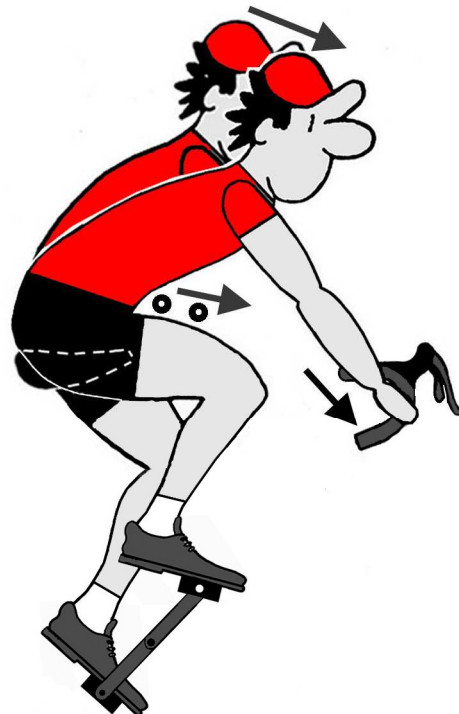
Figure 10.8. Le centre de masse du cycliste se déplace vers l'avant et vers le bas quand il met les mains aux cocottes et encore plus quand il met les mains au bas du cintre.
